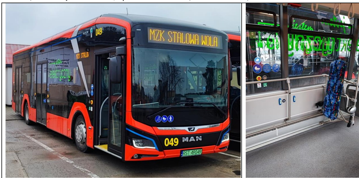
Rys. 9.2 W pełni niskopodłogowy autobus elektryczny typu MAXI oraz miejsce dla wózka inwalidzkiego lub dziecięcego wewnątrz autobusu
